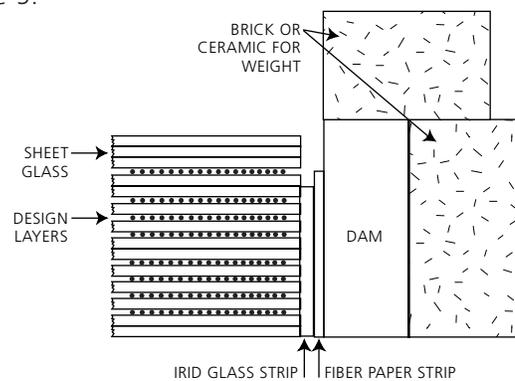
CROSS-SECTION OF SINGLE-FIRE STACK
