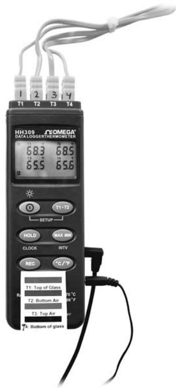
FIGURE 2: SOME PYROMETERS CAN RECORD DATA.
